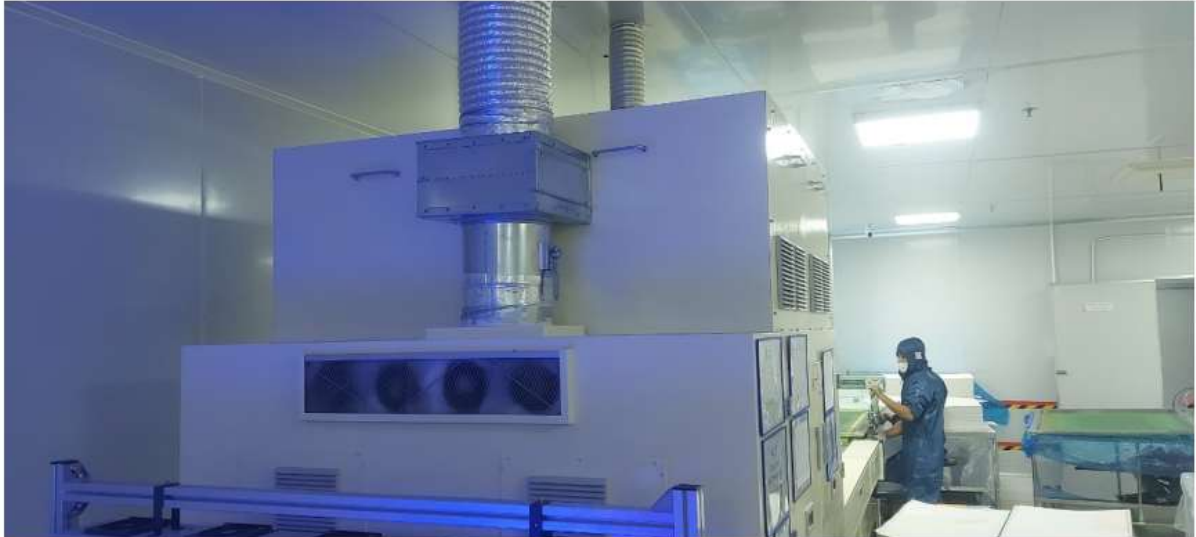
Hình 1. 7: Hệ thống sấy bằng tia cực tím có trang bị ống dẫn thoát nhiệt thừa
