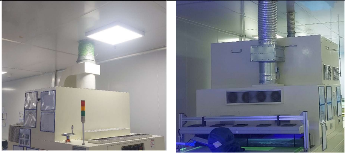
Hình 3. 7: Hệ thống máy sấy UV có lắp đặt ống dẫn thoát nhiệt, hơi nóng ra bên ngoài
